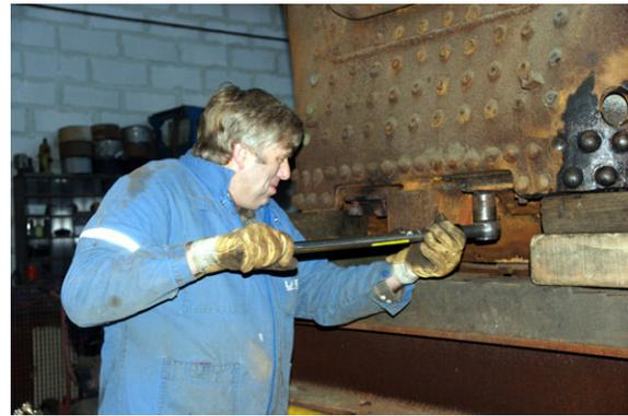
Certains écrous nécessitent d'abord d'être chauffés au rouge avant d'être (lentement) dévissés à l'aide d'un cliquet
