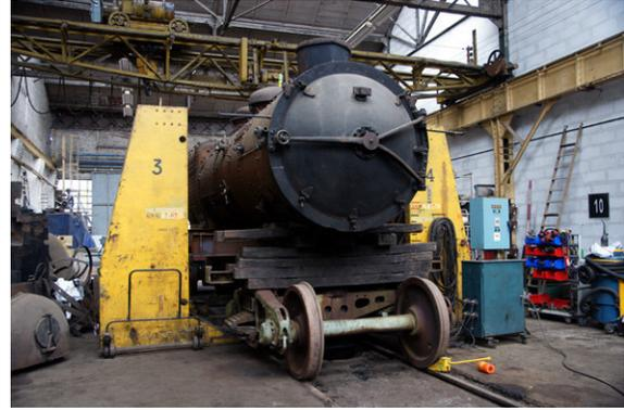
La stabilité de la chaudière a été renforcée par la mise en place de tours de levage supportant des poutres métalliques
