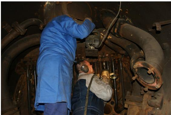
Début de dépose des écrous de fixation d'un tube surchauffe à l'aide d'une dévisseuse pneumatique
