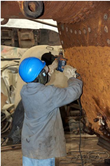
Le corps de la chaudière est soigneusement brossé afin de faciliter les mesures d'épaisseur par l'APAVE
