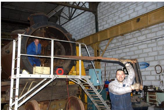
Le premier tube de surchauffe est en train d'être sorti de la chaudière. La longueur cumulée des 32 tubes de surchauffe avoisine les 500 mètres!
