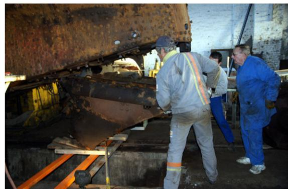
La partie arrière du cendrier est démontée
