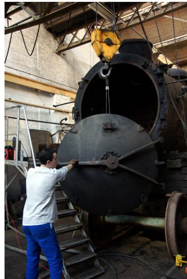
La porte de la boîte à fumée est déposée. Elle tare dans les 380 Kilos (!)
