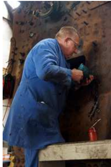
Certains gougeons vont devoir être remplacés. Ici Bernard tente d'en percer un qui s'est cassé au démontage d'une pièce en vue de le remplacer.
