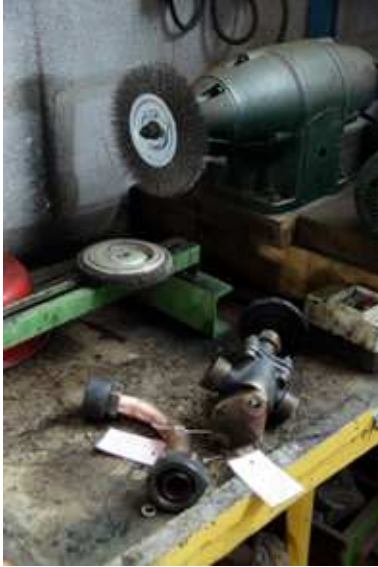
Le nettoyage approfondie des pièces déposées entraîne une usure prématurée de la brosse de la tourelle !
