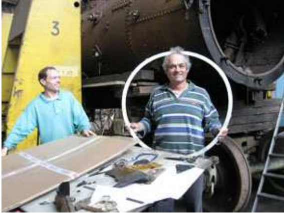
Xavier et Philippe viennent de recevoir les nouveaux joints des dômes vapeur.
