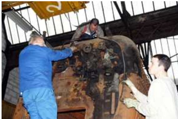
La poursuite du démontage des différentes pièces sur la chaudière se poursuit.
